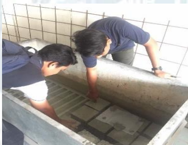
Foto 3.11 Biarkan selama sehari dan acuan ujian kiub dibuka untuk curing.
