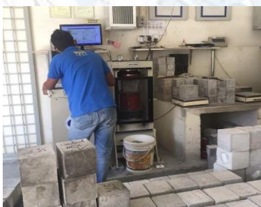
Foto 3.12 Membuat ujian kiub pada hari ke 7, 14, dan 28.
